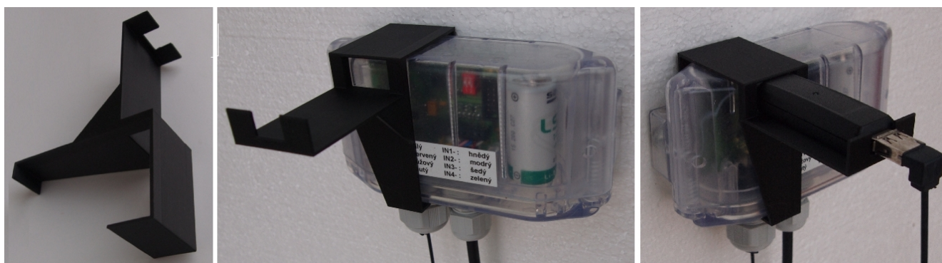
Obr. 11: Uchycení optického převodníku do přípravku
