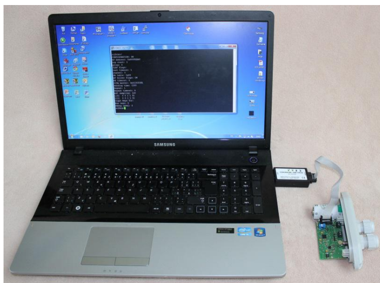
Obr. 3: Konfigurace modulu přes USB port počítače
